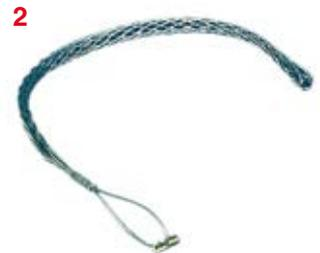
**3 Kabeleinziehstrumpf für Kabel-Jet und Röhrenaal aus Stahl** für den unterirdischen Leitungsbau, **eine Schlaufe**, verzinkte Stahlhitze, zurückgeflochtene Enden, Wirklänge 900 mm
