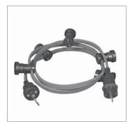
Illuminations-Lichterketten mit montierten Fassungen, ohne Stecker und Endstück 100 m Illuminationsleitung HO5RN H2x1,5 mm², Grün Für Innen- und Außenbereiche Mit montierten E27-Fassungen und Lampendichtung Max. 100 m mit 60 Fassungen zulässig
