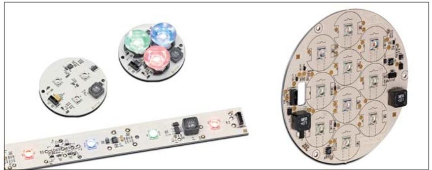
Die lineare Bauform ist beispielsweise für Wall-washing- und Linear-Leuchten, etc. geeignet. Um ein einfaches Systemverständnis herzustellen, werden die Module mit 24 V DC betrieben. Die Konstantstromregelung der LEDs befindet sich auf der Platine. Die Kontaktierung erfolgt über einen On-board-Steckverbinder mit zugehörigen Verbindungskabeln. Für die Verwirklichung individueller Lichtlösungen stehen zusätzlich entsprechende Farbsteuermodule (DigiLED CA-Serie) und Aufsatzoptiken zur Verfügung.
