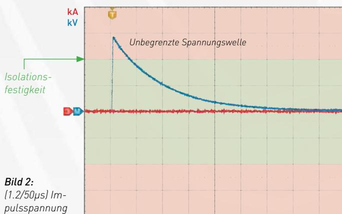
**Bild 2:** (1.2/50µs) Impulsspannung
